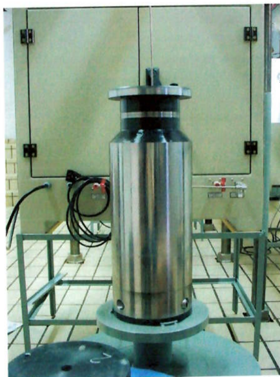
Figura 12 – Célula triaxial montada sobre a base com a unidade de carga ao fundo
